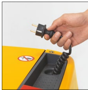
Встроенное зарядное устройство рассчитано также на батареи большей емкости
