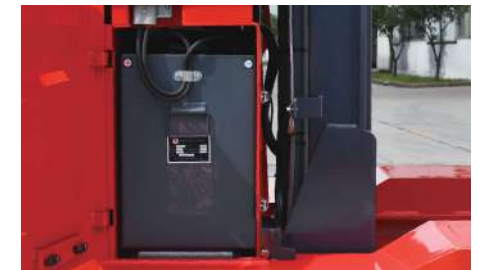
Боковая замена батареи
