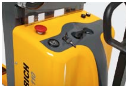
Наглядное расположение органов управления и индикации
