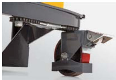
Ведущее колесо со стояночным тормозом
