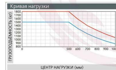
**Примечание:** Вертикальная ось соответствует грузоподъёмности, а горизонтальная ось соответствует центру нагрузки, измеряемому от передней стороны вил до центра тяжести стандартного груза. Стандартным грузом считается куб со стороной 1000 мм, следовательно, расстояние до центра нагрузки равно 500 мм. Грузоподъёмность уменьшится в случае наклона мачты вперед или использования нестандартных вилок, так как расстояние до центра нагрузки при этом увеличивается.
