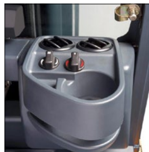
Отопление, включая дефлекторы ветрового стекла
